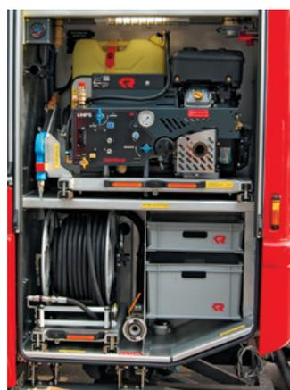
UHPS SKID 200 con bastidor extraíble— montado en un vehículo municipal
